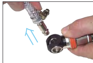
Stecker wird drucklos entnommen.
